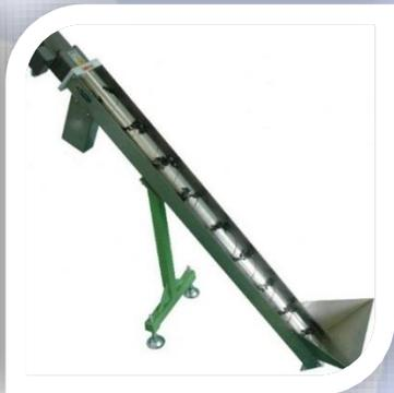
マグネットコンベアーは、機械部品加工会社の機械に取り付けて、切り粉をクーラント液の中から自動的に取り出すことによって、クーラント液の寿命を延ばし、クーラント液の使用量を減らす効果があります。(廃液が減る)
