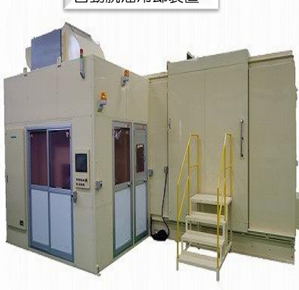
自動脱油冷却装置
